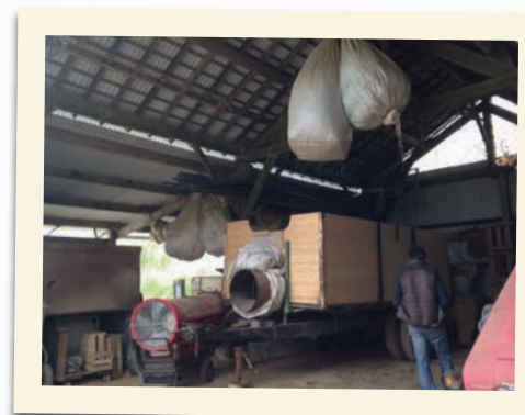
Benne à double fond séchant+ bruleur anti-humidité
